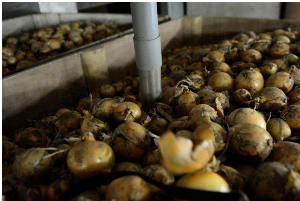
Foto 2: continu meting van RV en temperatuur
