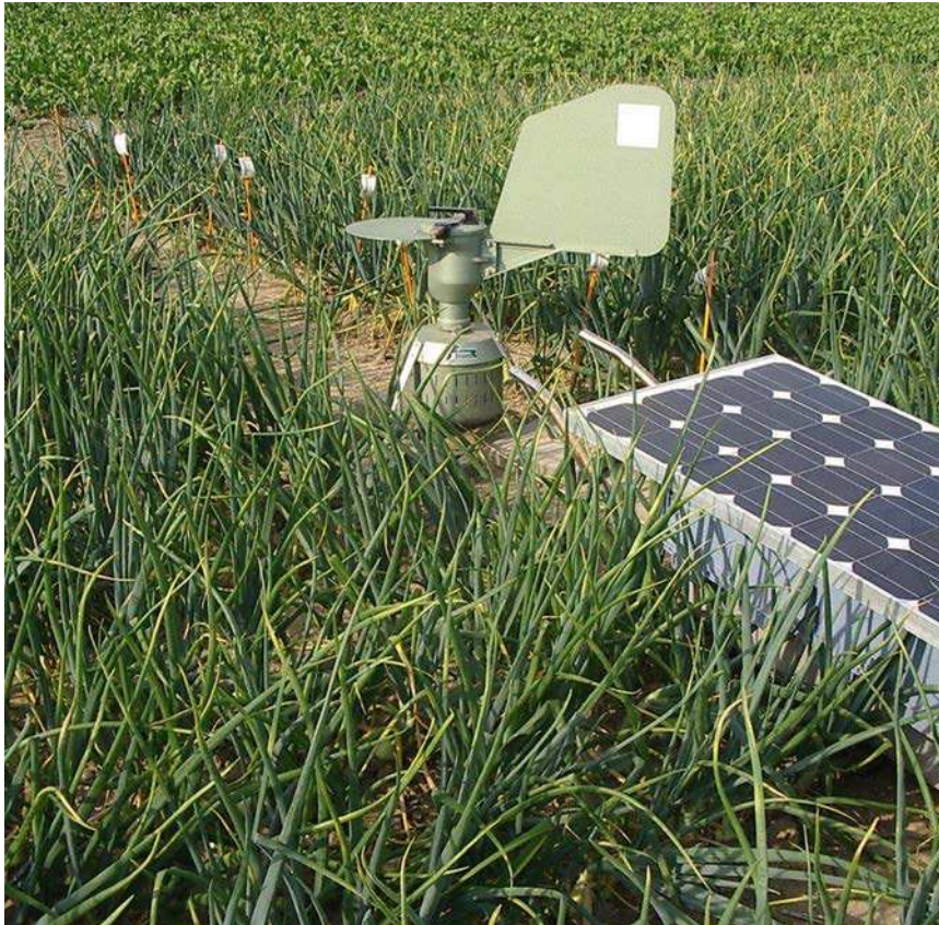
Figuur 6 Burkhard sporenvanger waarmee de mate van sporulatie kan worden bepaald.
