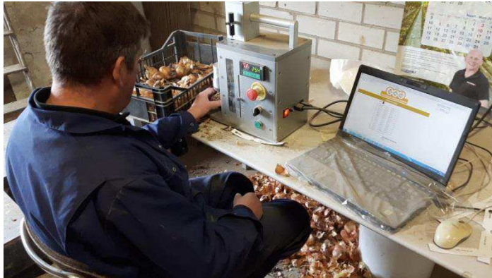
Afbeelding 2.4. meten van de hardheid
