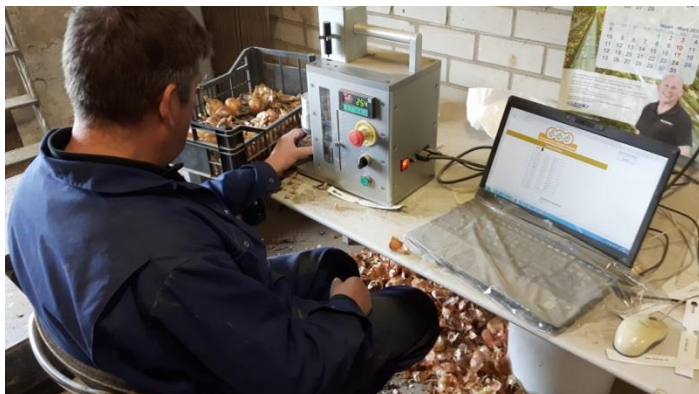
Afbeelding 2.1. meten van de hardheid
