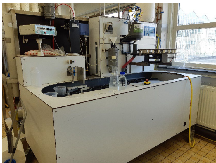
Figuur 3.2. Zonale centrifuge. Op de onderste carousel worden de monsters in 1 L-bekerglazen naar de centrifuge geleid, op de bovenste carousel worden de monsters na extractie in 150 mL-bekerglazen opgevangen. De kom van de centrifuge is uit veiligheidsoverwegingen in een houder aangebracht. De MgSO_4 wordt door leidingen in de kom van de centrifuge gebracht. Foto: WUR Open teelten.
