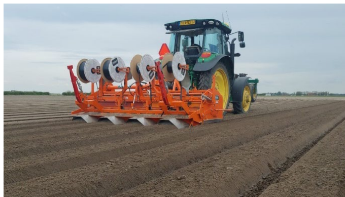
Afbeelding 2. Maken van de ruggen incl leggen van druppelslangen
