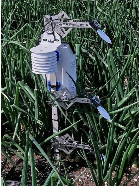
Figuur 2. Meetopstelling in de zaaiuien voor de bepaling van het microklimaat.
